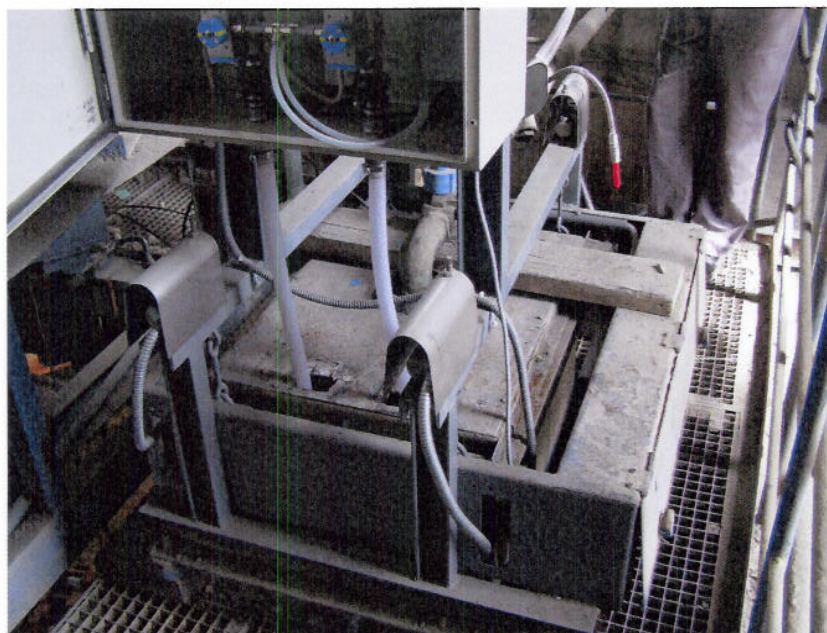
Vaga za vodu i način oslanjanja na MPS
