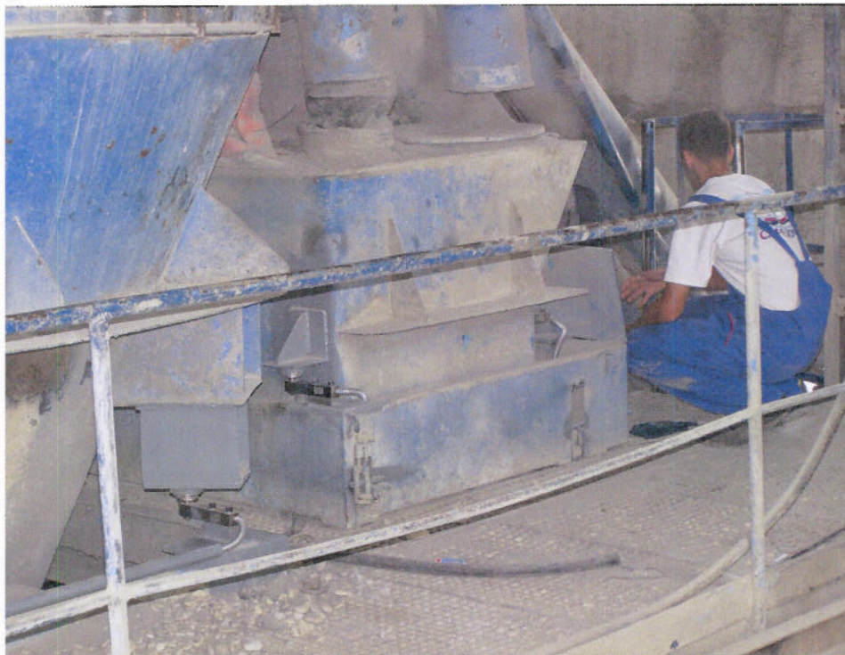
Vaga za cement (desno) i vaga za agregat (lijevo), i način oslanjanja na MPS.
